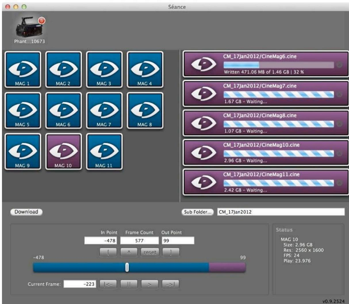
Les outils Glue tools Séance et cine tool kit permettent le pilotage de la caméra, de la Cinestation et le déchargement des rushes. Cette suite logicielle compatible Mac OSX, dont l'ergonomie est incomparable, améliore le confort de travail. La compatibilité QuickTime, Final Cut Pro et Avid se révèle indispensable par le confort apporté. Ainsi, la simplification de la gestion des rushes rend la PHANTOM FLEX bien plus simple et accessible qu'auparavant.
